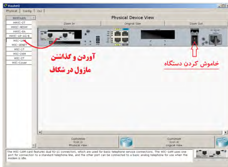
شکل ۱-۲ برگه Physical پنجره تجهیز
