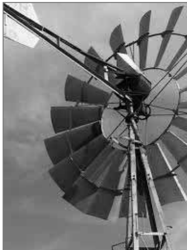
شکل ۱-۶ آسیاب بادی آمریکایی با پره‌های فولادی
